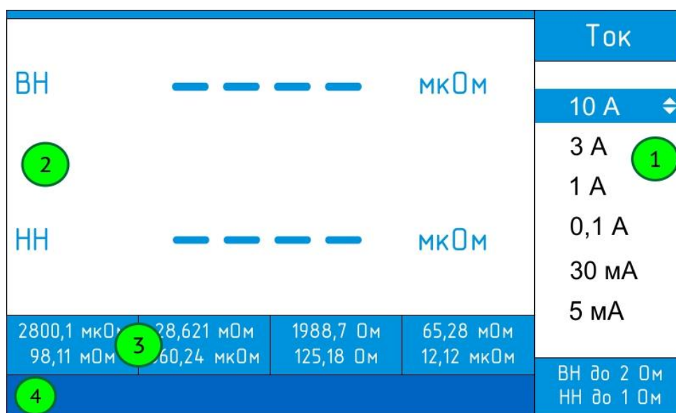
Рис. 14. Экран режима одиночных замеров индуктивных цепей.
